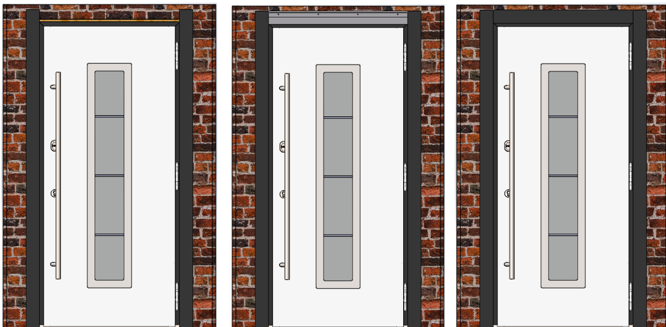
Эскиз № 11: установка наличников с внешней стороны дверного блока
