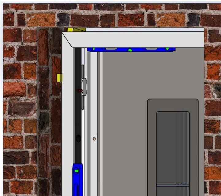
Эскиз №3: установка коробки по уровню на распорные клинья.
