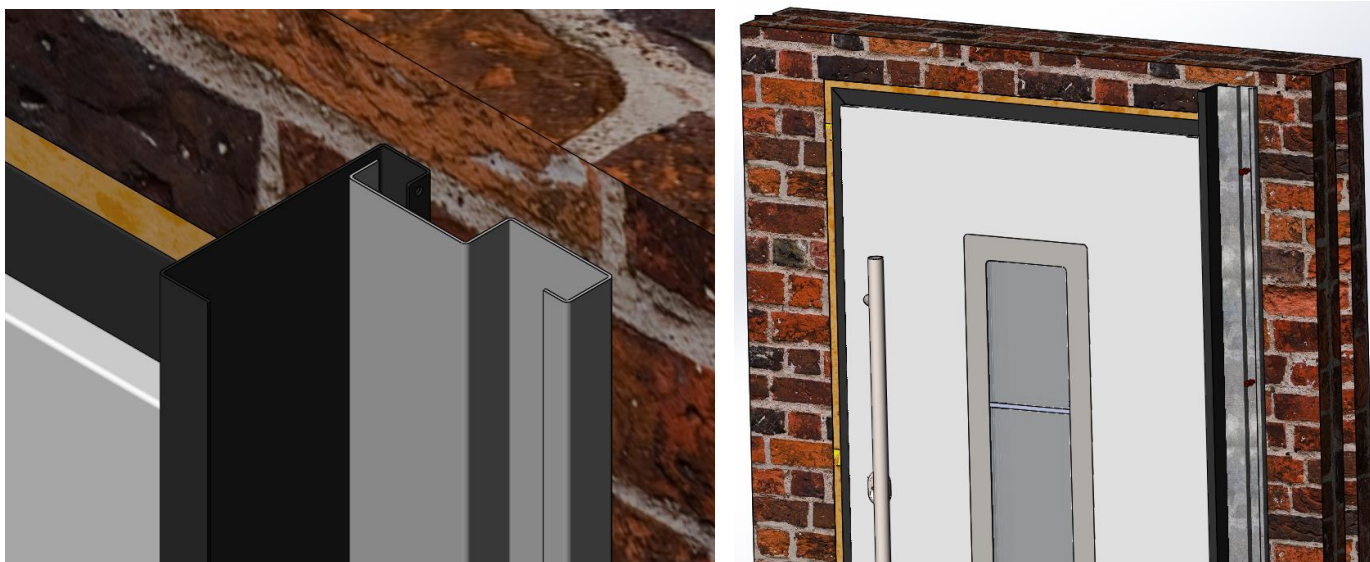
Эскиз № 8: крепление наличника со стороны петель
